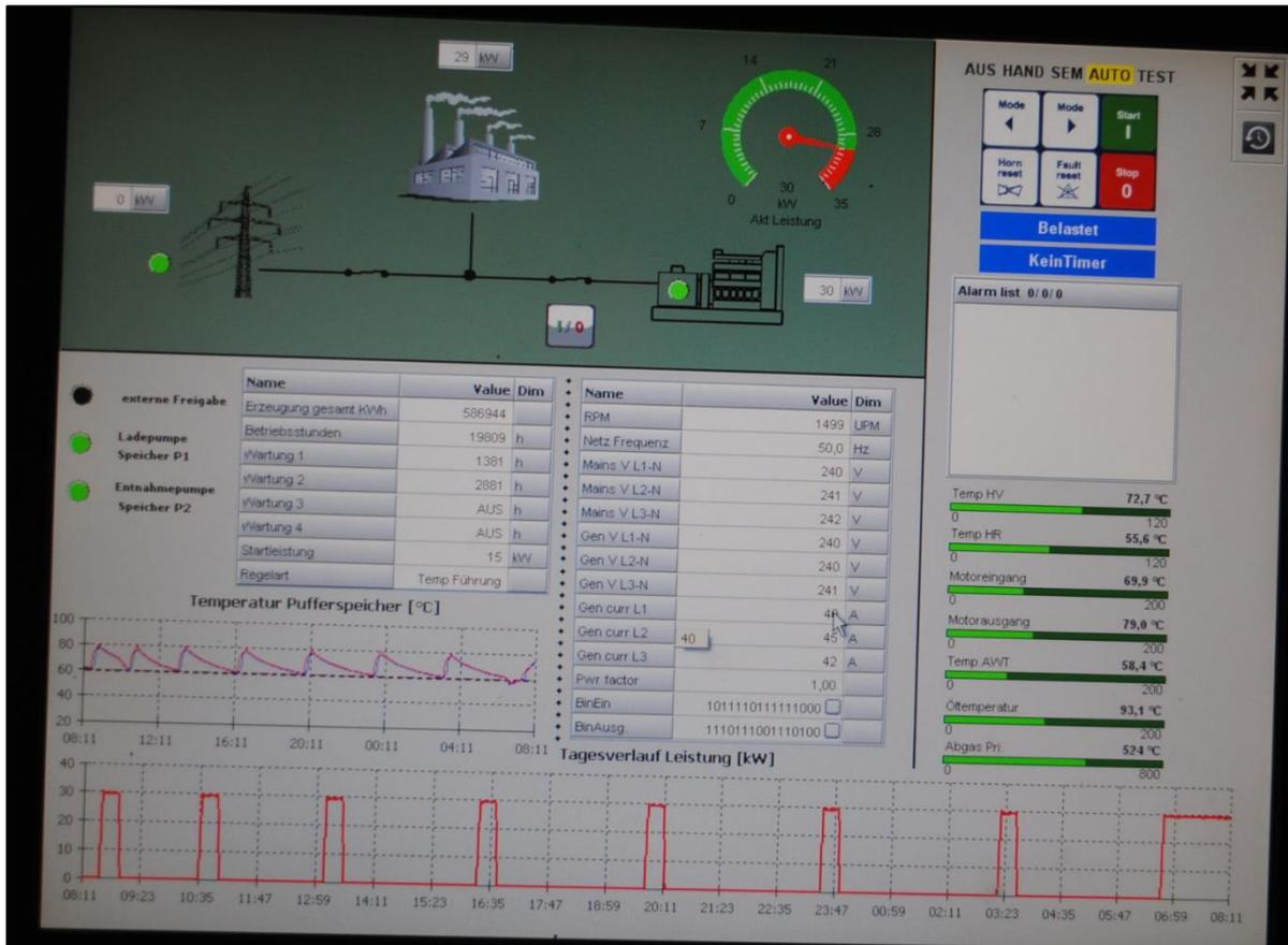
**ABBILDUNG 18: STATUSANZEIGE AM 27.05.2019: DIE UNTERE LINIE ZEIGT AN, DASS DAS GEBÄUDE KAUM NOCH WÄRME BENÖTIGT UND DAS WÄRMEGEFÜHRTE BHKW DESHALB NUR ZEITWEISE LÄUFT**
