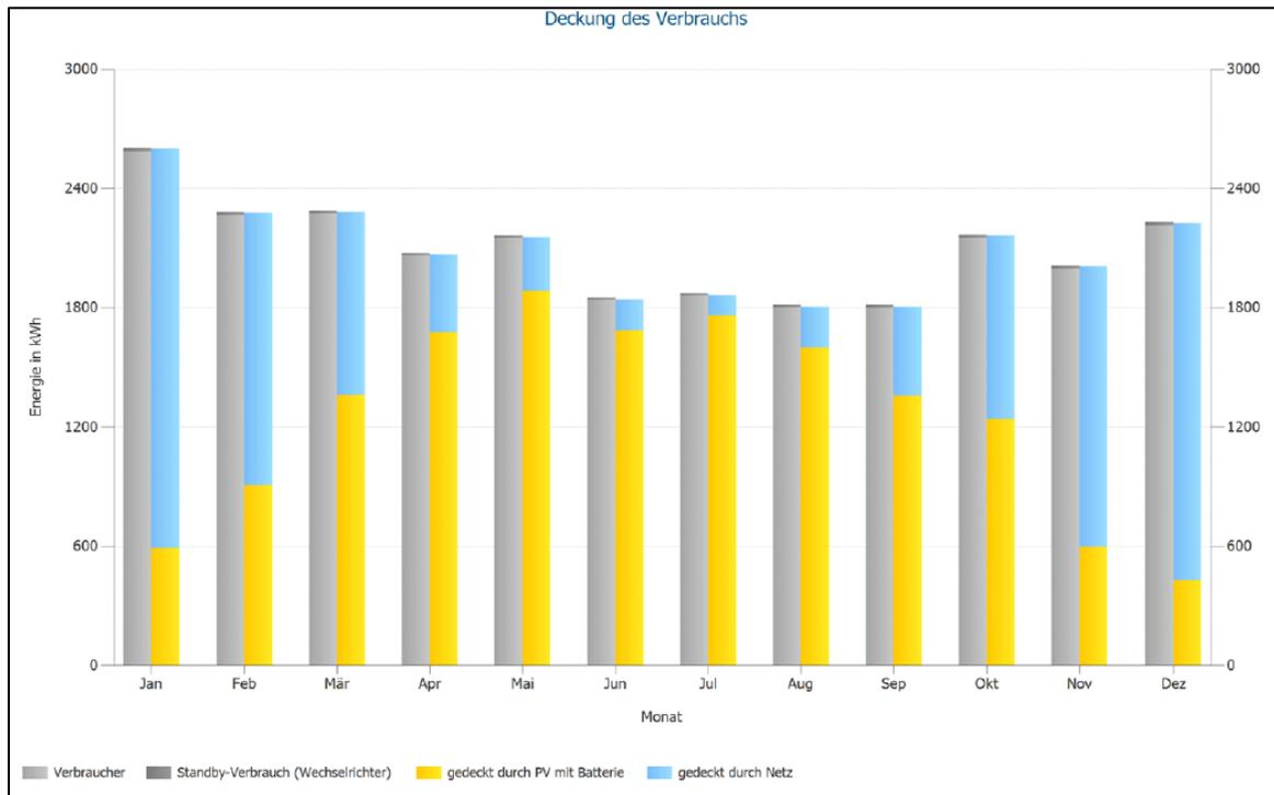
**ABBILDUNG 23: STROMBEZUG DER RETTUNGSWACHE IM JAHRESVERLAUF MIT DARSTELLUNG DES BEZUGS VON DER PV-ANLAGE (GELB) UND AUS DEM ÖFFENTLICHEN STROMNETZ (BLAU) (QUELLE: HILLE ENERGIESYSTEME, STEINFURT)**
